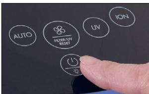
9. Maintenez la touche de **régulation de puissance** enfoncee pendant environ 5 secondes jusqu'à ce que l'avertissement du filtre disparaisse de l'écran.
