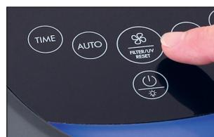
Al apagar el aparato, se guardará el último ajuste, que aparecerá la próxima vez que se encienda. En cambio, si desconecta el Therapure TP350 de la red eléctrica, la próxima vez que lo encienda se activará el modo automático.
