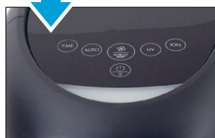
Al apagar el aparato, se guardará el último ajuste, que aparecerá la próxima vez que se encienda. En cambio, si desconecta el Therapure TP350 de la red eléctrica, la próxima vez que lo encienda se activará el modo nocturno.
