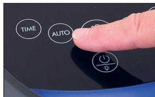
3. Appuyez sur la touche du **niveau de puissance** pour quitter le mode auto et passer en mode manuel. Chaque pression permet de commuter entre les niveaux de puissance : I > II > III > I
