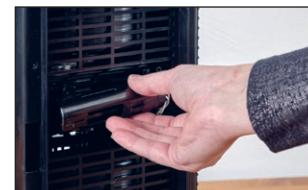
7. Ouvrez le clip présent sur le câble pour séparer la lampe UV de l'appareil.
