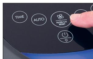
Le dernier réglage est enregistré à l'arrêt et rétabli à la prochaine mise en marche. En revanche, si vous débranchez le Therapure TP350 du réseau électrique, le mode auto sera activé à la prochaine mise en marche.
