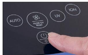
7. Mantenga pulsada durante 5 segundos la tecla de control de potencia hasta que desaparezca la señal de advertencia "UV" en el panel.
