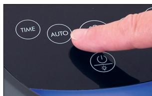
3. Pulse la tecla de **nivel de potencia** para salir del modo automático y pasar al modo manual. Cada vez que se pulsa la tecla, se cambia entre los diferentes niveles de potencia: I > II > III > I
