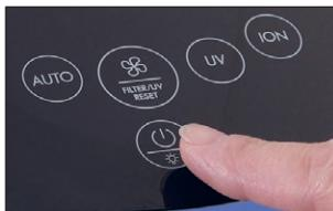
9. Mantenga pulsada durante 5 segundos la tecla de control **de potencia** hasta que desaparezca la advertencia del filtro en el panel.
