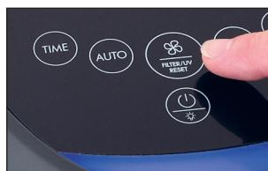
Le dernier réglage est enregistré à l'arrêt et rétabli à la prochaine mise en marche. En revanche, si vous débranchez le Therapure TP450 du réseau électrique, le mode auto sera activé à la prochaine mise en marche.
