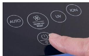
7. Maintenez la touche de régulation de puissance enfoncée pendant environ 5 secondes jusqu'à ce que le signal d'avertissement UV disparaisse de l'écran.
